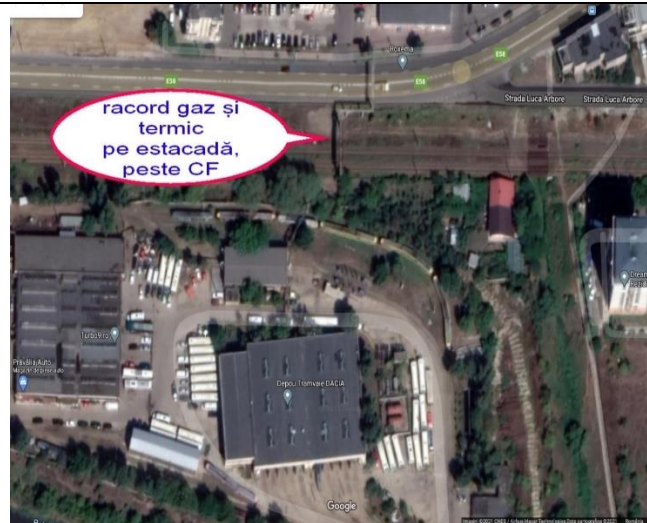
Bransamentul la rețeaua termică a orașului este poziționat pe latura de nord a incintei Depou.
